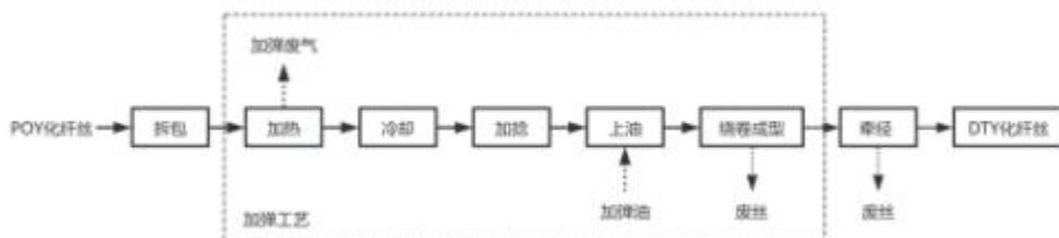
图 3-4 本项目化纤丝生产工艺及产污流程图
