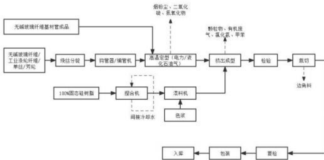
图 3-7 F、H 级以上耐高温车用传感器绝缘材料生产工艺及产污流程图
