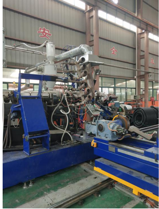
废气收集装置
