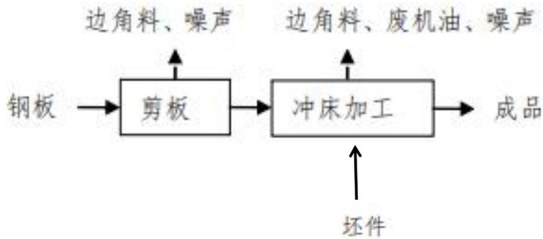
图 3-5 项目生产工艺流程图
