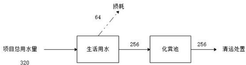
图 3-4 项目水平衡图 (单位 t/a)
